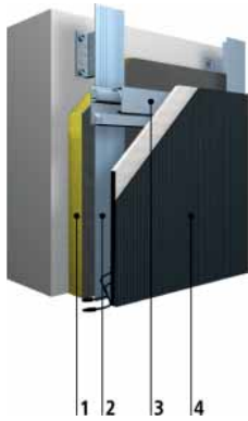
1 izolacija 2 podkonstrukcija 3 agrafni profil 4 StoVentec ARTline Invisible
