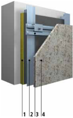
1 izolacija 2 podkonstrukcija 3 agrafni profil 4 StoVentec Stone Massive
