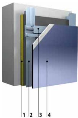
1 izolacija 2 podkonstrukcija 3 agrafni profil 4 StoVentec Glass
